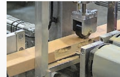
Schließblechbearbeitung Processing the door lock
